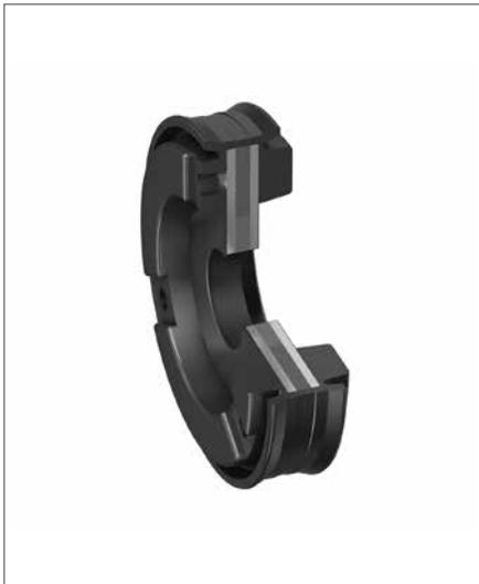
Der doppelwirkende Pneumatik-Komplettkolben DR ist ein Mehrkomponenten-Dichtungsdesign, bestehend aus einem mehrteiligen metallischen Trägerelement mit anvulkanisiertem Führungssteg, Dichtlippen und integriertem Magnet zur induktiven Positionsabfrage. Der Komplettkolben erfüllt vier Funktionen: **Abdichten, Führen, Positionsabfrage und Endlagendämpfung.**
