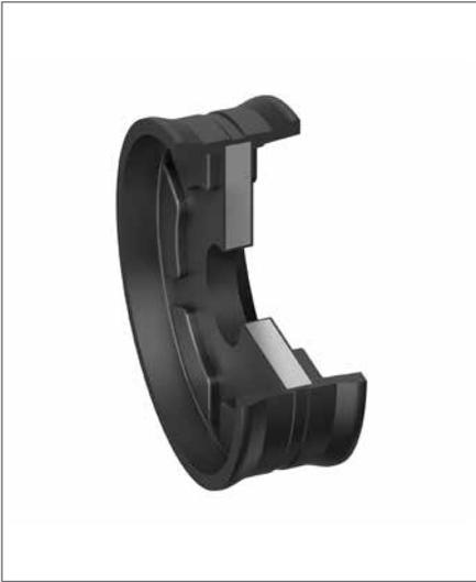
Der doppeltwirkende Pneumatik-Komplettkolben DK ist ein Zwei-Komponenten-Dichtungsdesign, bestehend aus einem metallischen Trägerelement mit anvulkanisiertem Führungssteg und Dichtlippen. Der Komplettkolben erfüllt zwei Funktionen: **Abdichten und Führen**.
