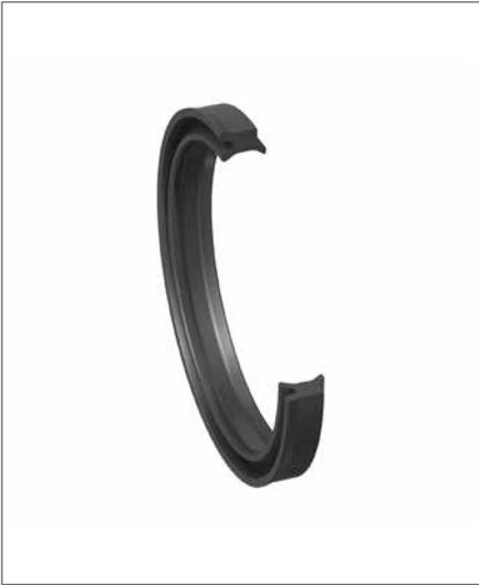
Der Dicht-Abstreifring EM für die Pneumatik ist ein bewährtes Kombinationselement für die Abdichtung von Kolbenstangen in kompakten Pneumatikzylindern und Ventilstößeln. Das spezielle Design im verschleißfesten Ultrathan®-Werkstoff ermöglicht kleinste Einbauträume und dadurch äußerst geringe Losbrech- und Gleitreibung.
