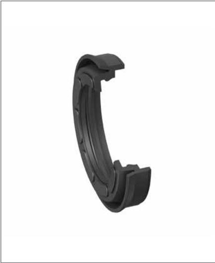
Die Kolbendichtung MK aus verschleißfestem Ultrathan® ist ein Dichtelement mit integriertem Führungssteg und Dämpfungspuffern. Das Dicht-Führungselement kann auf Kolben sowohl mit als auch ohne Dauermagnet eingesetzt werden. Beim Einsatz in Magnetkolben kapselt das Dicht-Führungselement den Dauermagneten ein. Die stirnseitig angebrachten Dämpfungspuffer dienen der Anschlagdämpfung. Bei doppeltwirkenden Zylinderdesigns kann das Dichtungsprofil MK auch in Back-to-Back-Anordnung eingesetzt werden.
