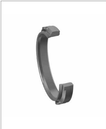
Der Ultrathan®-Dämpfungsring PP dichtet Dämpfungskolben in Pneumatikzylindern im Endlagenbereich ab. Seine spezielle Formgebung sorgt mittels der Dichtlippe für Dichtwirkung zum Dämpfungskolben und ermöglicht gleichzeitig eine Ventilfunktion beim Rückhub. Die Kombination aus Geometrie und Werkstoff gewährleistet hohe Verschleißfestigkeit.
